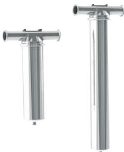
Binks Kartuschenfilter halten Schmutz und Farbklumpen durch eine Auswahl an Einweg- oder Mehrwegfiltern von Ihrem Farbssystem fern. Sie ermöglichen einen einfachen und schnellen Wechsel der Filterelemente durch Ihren Schnellverschluss. Das Gehäuse beinhaltet einen integrierten Manometeranschluss zum Messen der unterschiedlichen Materialdrücke.
