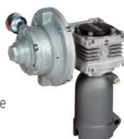
Geschwindigkeit: Die Geschwindigkeit des Luftmotors wird von einem Luftstellventil reguliert (Artikelnummer HAV-500). Die Geschwindigkeit der Rührwerkswelle unter dem Reduzierungskasten sollte maximal 30 bis 40 U/min betragen.
