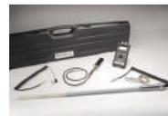
Das umfangreiche Ransburg Test-Equipment ist in einem stabilen Koffer untergebracht und ermöglicht durch eine regelmäßige Kontrolle und Überwachung der Rahmenbedingungen des Beschichtungsvorganges eine jederzeit perfekte Oberflächenqualität sowie geringere Ausfallzeiten und Materialverluste. Das Ransburg Test-Equipment ist kompakt und leicht. Mit Hilfe des digitalen Messgerätes erhält man genaue Ergebnisse innerhalb von Sekunden.
