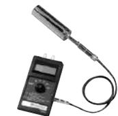
Mit dem Multifunktions-Elektrostatikmessgerät von Ransburg können bei der elektrostatischen Beschichtung Leitfähigkeit, Lackwiderstand, Kurzschlussstrom, Widerstand und Hochspannung gemessen werden. Das Messgerät ist einzeln für Messung von Leitfähigkeit und Lackwiderstand, oder als Deluxe-Ausstattung für alle oben genannten Messfunktionen, erhältlich.
